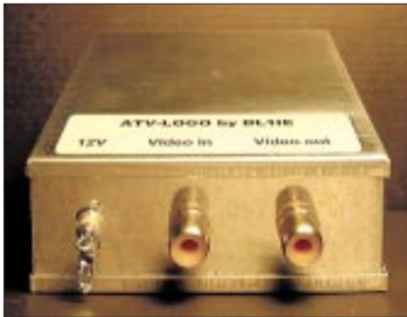
Bild 9: Seitenansicht der Baugruppe – links ist der Durchführungskondensator für die Betriebsspannung zu erkennen.
