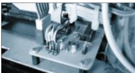
Bild 4: Blick von oben auf die Platine. Die grüne LED zeigt an, daß nach rechts gedreht wurde.
