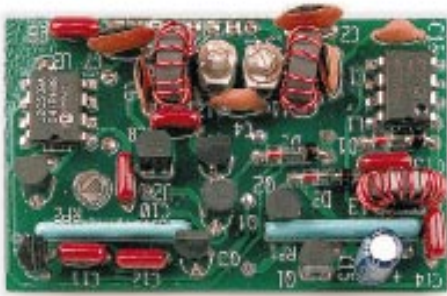
Bild 9: Für 29 US-Dollar kann man diesen hochwirksamen Noiseblanker als Option erwerben: Löt und Plug and Play
