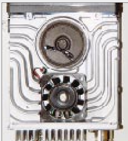
Bei den geringen Geräteabmessungen kommt der Kühlung besondere Bedeutung zu. Hier ein Blick auf die Luftkanäle. Fotos: Autor
